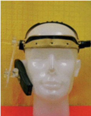
Illustration 2 : Mesure de l'indice DAS au moyen d'une tête « fantôme ». Source de l'image : [13]
