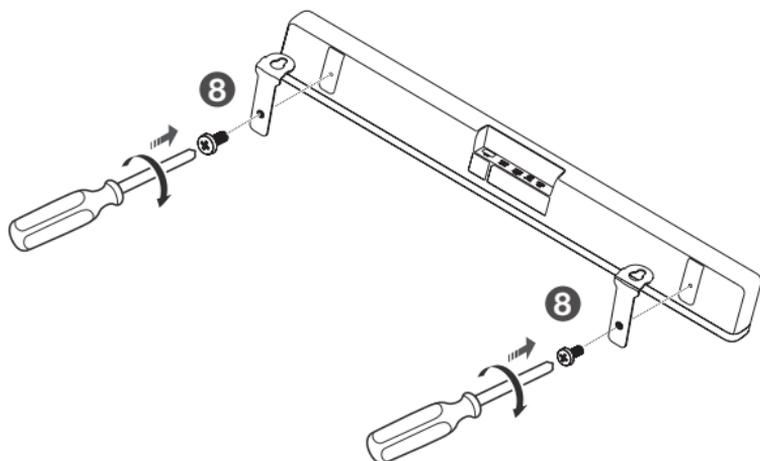
10 Fixez et serrez les vis des supports muraux sur le mur.
